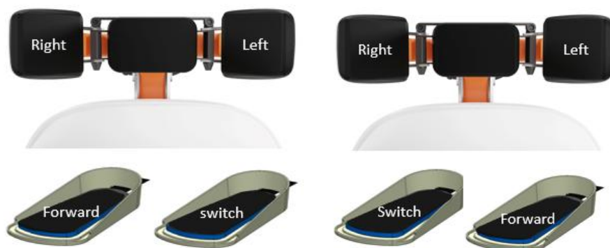
Figuur 15. Rijden met de voet – Schakelen met de voet configuratie.
