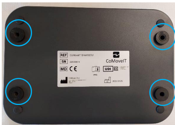
Figuur 13. Blinde moeren gepositioneerd in de 4 gaten van de ECU
