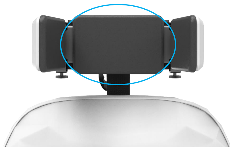
Figure 7. Pad arrière de la commande occipitale où la matrice de capteurs de force est intégrée.
