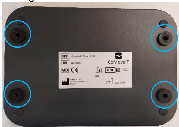
Figure 13 - écrous borgnes positionés dans les quatre trous du UCE
