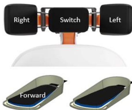
Figure 17. Conduire avec un pied - Commuter avec l'arrière de la tête.
