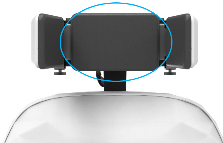
Abbildung 7. Hinteres Pad der Kopfsteuerung, in dem die Kraftsensormatrix integriert ist.
