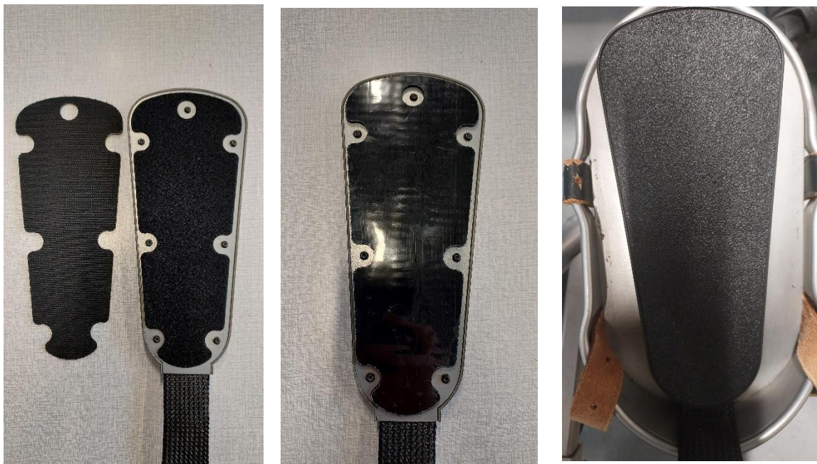
Abbildung 12. Klettverschluss zum Verbinden der Fußsteuerung mit der Fußplatte des Rollstuhls.
