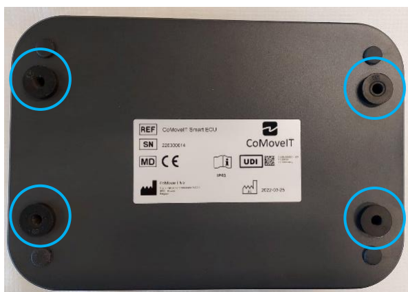
Abbildung 13. Blindmuttern in den vier Löchern der elektronischen Steuereinheit.
